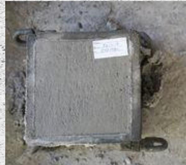
Se identifica el espécimen usando algún procedimiento que no altere la superficie expuesta
